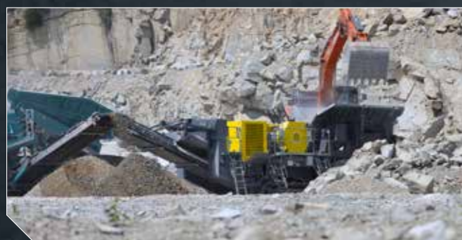
Aufbereitung von Granit mit dem RM J110X und einem 16' x 5' Schwerlastsieb
