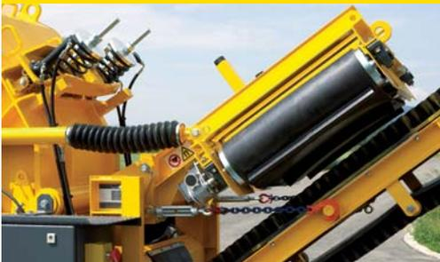
Unverzichtbar: Release-System zur Blockagenbeseitigung und zuverlässiger Magnetabscheider
